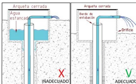
Figura 4: Pozo situado bajo la superficie del terreno.
