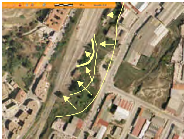
Ortofotografía aérea de la zona de la estación del ferrocarril y su entorno, con el polígono industrial El Cerro y el antiguo almacén de máquinas; en amarillo, las sucesivas reactivaciones del movimiento de ladera. SIGPAC.
