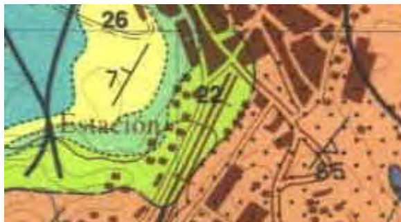
Mapa geológico a escala 1:50.000 de Segovia (483), con el detalle del entorno de la estación de trenes de Segovia, a caballo entre las rocas metamórficas (color anaranjado) y las rocas sedimentarias (colores verdes, azules y beige). Fuente: IGME ( www.igme.es ).
