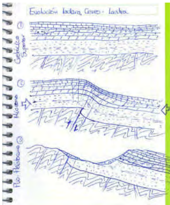
Notas en el cuaderno de campo con la secuencia evolutiva de cortes geológicos para el entorno de la estación de ferrocarril de Segovia, desde el Cretácico superior (1) hasta la década 1980-1990 (6).
