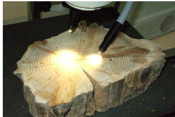
Conteo y medición de la anchura de los anillos en varios radios de una misma rodaja con el empleo de la mesa de medición LINTAB TM .
