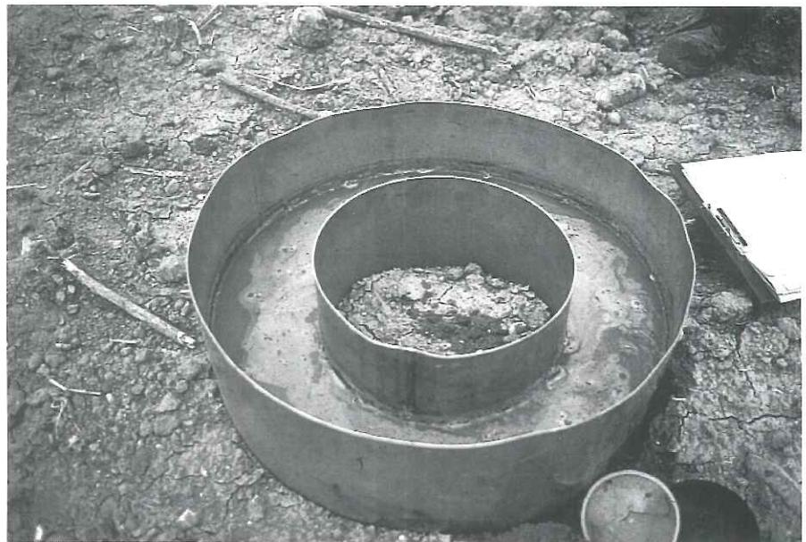
Ensayo de infiltración en materiales aluviales del aluvial de Deifontes.
