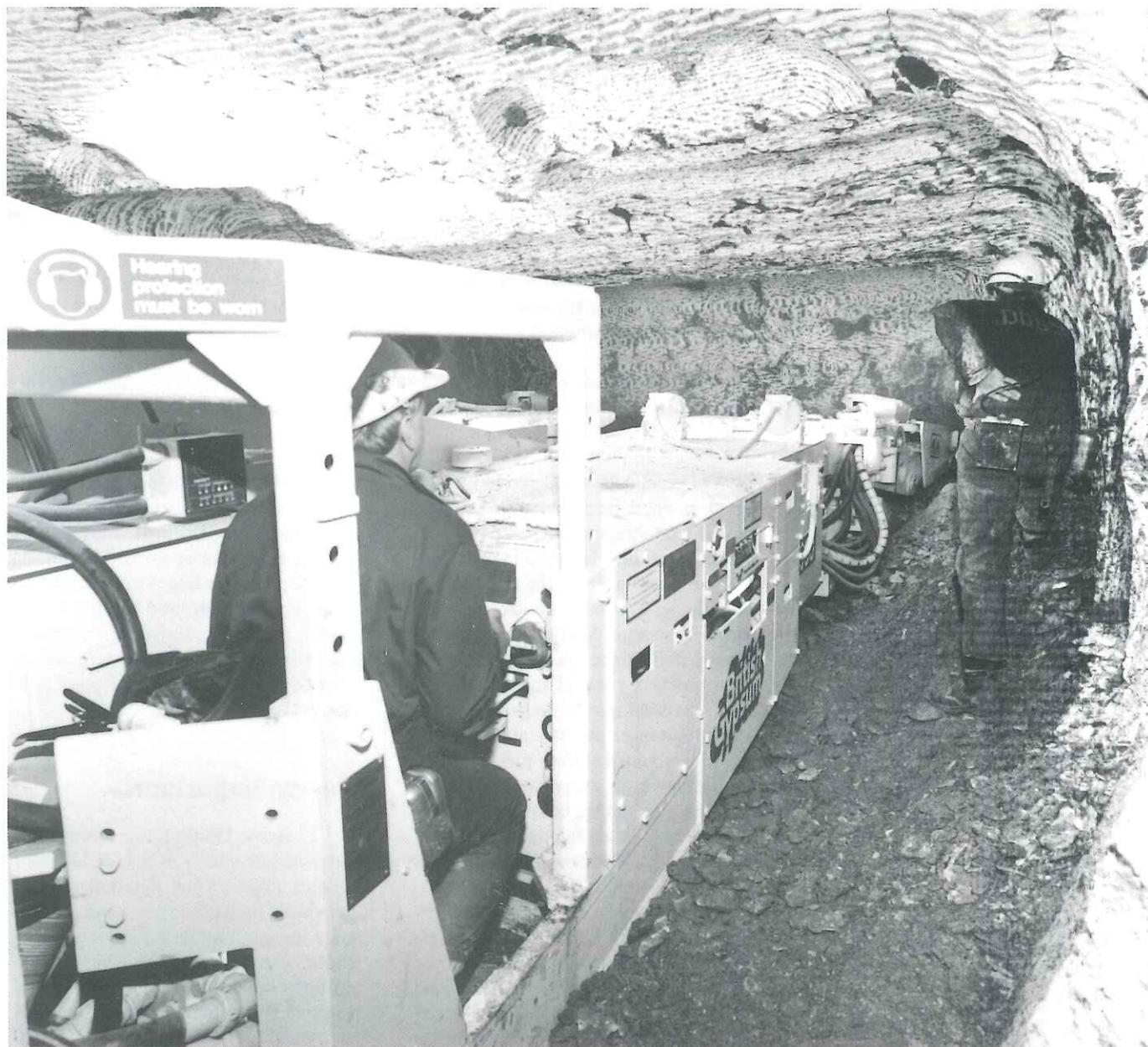
Una máquina de extracción DOSCO Digger en funcionamiento en una de las minas subterráneas de yeso de British Gypsum.
