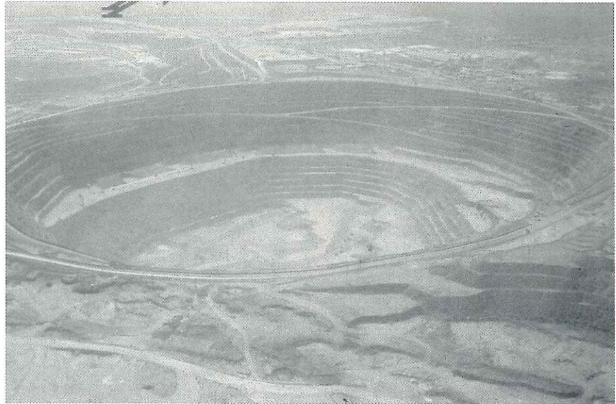
Foto 2.-Vista aérea de la explotación a cielo abierto del complejo carbonatítico circular de Palabora (Subáfrica). La corta en esta fotografía de 1986 tiene un diámetro próximo a 1,8 Km y una profundidad de 378 metros.
