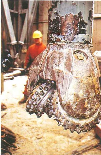
Fig. 8: Impresionante aspecto de un tricono utilizado en KTB-HB.
