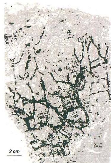
Fig. 5.-a) Medio fracturado simulado, con distribución fractal en la ubicación de las fracturas
