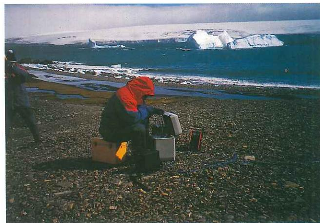
Fig. 5. Prospección sísmica para estudiar el relleno sedimentario y la estructura del sustrato.
