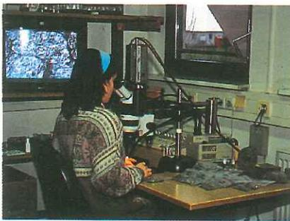
Fig. 6: Observación de «cuttings» en la lupa binocular.
