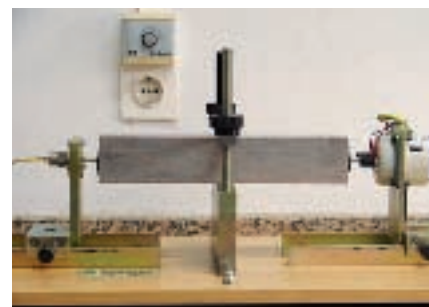
Figura 10. Equipo para medir la frecuencia de resonancia.
