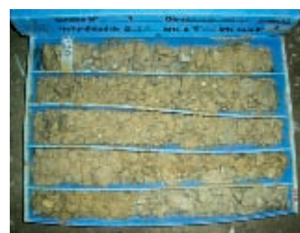
Figura 11. Máquina de sondeos para perforar a rotación con extracción de testigo continuo en terraza aluvial del Río Júcar: Las gravas y arenas se han podido recuperar ya que el tamaño de partícula, en general, es inferior al de la batería y no es un material altamente agresivo, por lo que no ha sido necesario emplear agua ni diamante.
