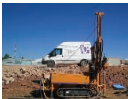
Figura 11. Máquina de sondeos para perforar a rotación con extracción de testigo continuo en terraza aluvial del Río Júcar: Las gravas y arenas se han podido recuperar ya que el tamaño de partícula, en general, es inferior al de la batería y no es un material altamente agresivo, por lo que no ha sido necesario emplear agua ni diamante.
