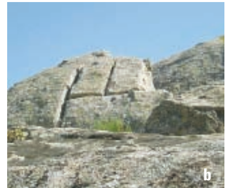
Figura 7. Vestigios de antigua actividad extractiva: (a) frente de banco de explotación de caliza (El Espartal, Madrid); (b) explotación de bolos graníticos mediante su fisuración con cuñas de madera a favor de su red de fracturas (El Escorial, Madrid).
