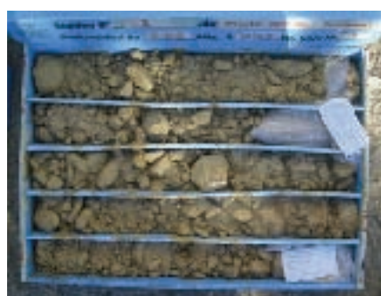
Figura 11. Máquina de sondeos para perforar a rotación con extracción de testigo continuo en terraza aluvial del Río Júcar: Las gravas y arenas se han podido recuperar ya que el tamaño de partícula, en general, es inferior al de la batería y no es un material altamente agresivo, por lo que no ha sido necesario emplear agua ni diamante.
