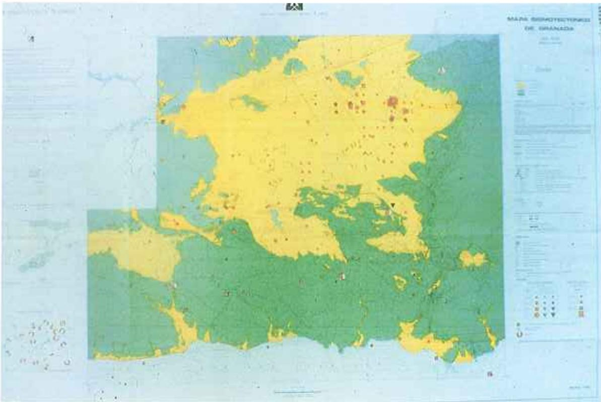
Mapa sismotectónico de Granada. En este tipo de mapas se muestran los datos de la sismicidad y de los factores geológicos que la condicionan, y se utilizan en la realización de proyectos de obras públicas y de edificación y en la planificación territorial. (Tomado de la colección de diapositivas de "Los Riesgos Geológicos", Instituto Tecnológico y Geominero de España).
