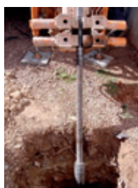
Figuras 5.B, 5.C y 5.D. Máquina de sondeos perforando directamente en la calicata con un ángulo de unos 30° y vista inferior del operativo de sondeo desde la calicata.
