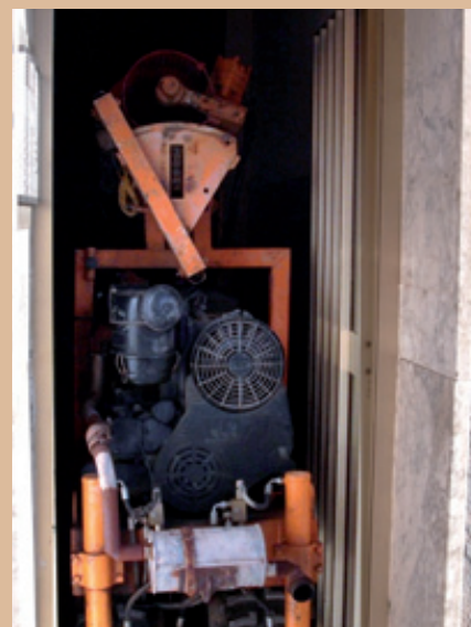
Figuras 14.A y 14.B. Edificio que presenta una patología y precisa de un estudio geotécnico para realizar un ascensor que presenta limitación tanto en anchura como en altura. Máquina entrando en dicho zaguán con entrada de 0,73 metros.
