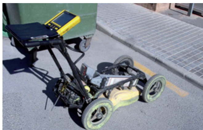
Figura 9.B. Antena georadar (GPR) de 250 MHz, que intentará realizar un radargrama con la silueta del cepellón de la palmera.
