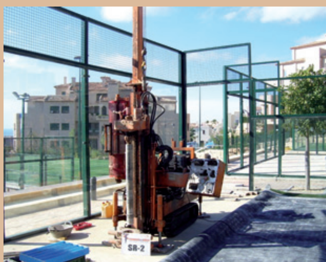
Figuras 16.A y 16.B. Campaña de campo consistente en sondeos geotécnicos para un informe patológico en pistas de pádel, en las que se tuvieron que quitar cristales laterales para su entrada.
