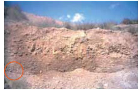
Figura 2. Corte de una balsa de purines en la que se observa la infiltración de los mismos en un medio permeable (conglomerado inconsolidado). En la esquina inferior izquierda se sitúa un martillo de geólogo como escala (círculo rojo).
