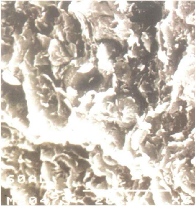
Figura 3. Microfábrica compacta y densa observada en las AAG sanas (MEB). X 3000.
