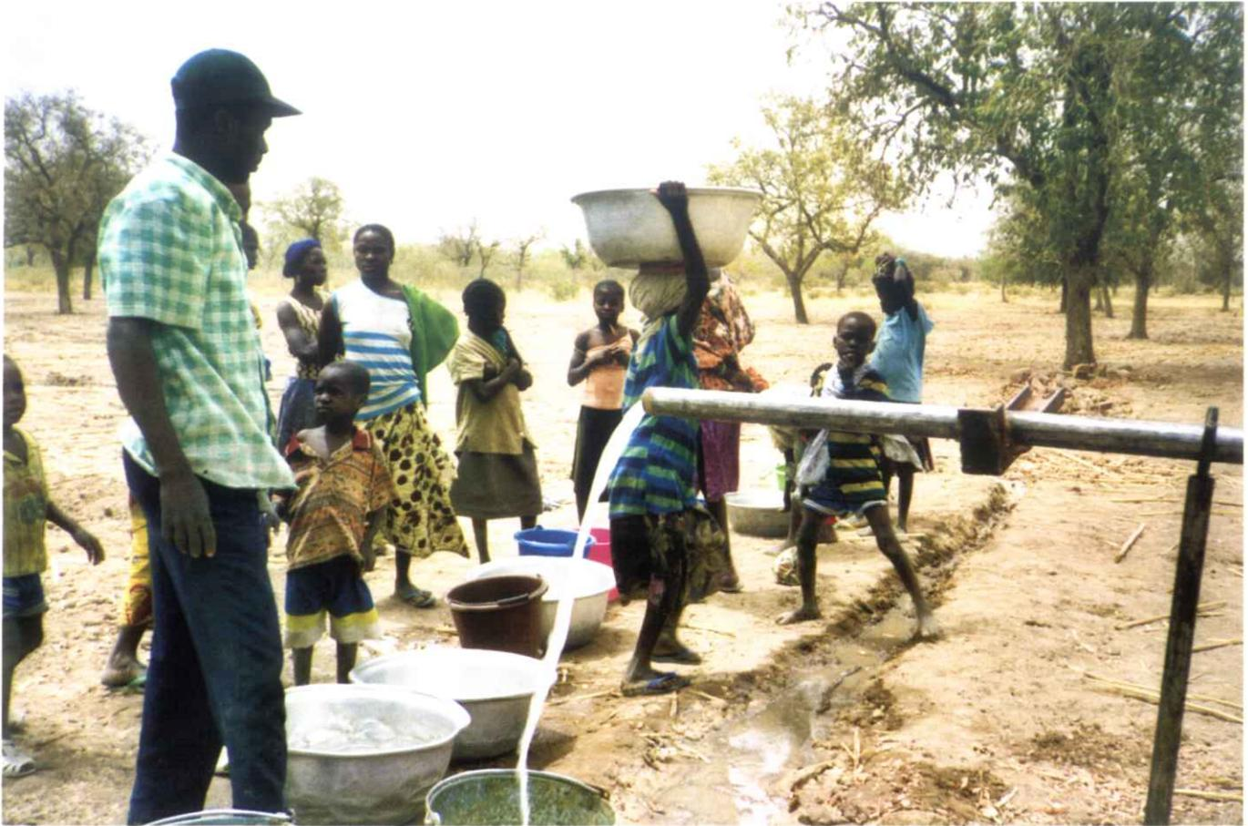
Figura 4. Aforo del sondeo mecánico.
