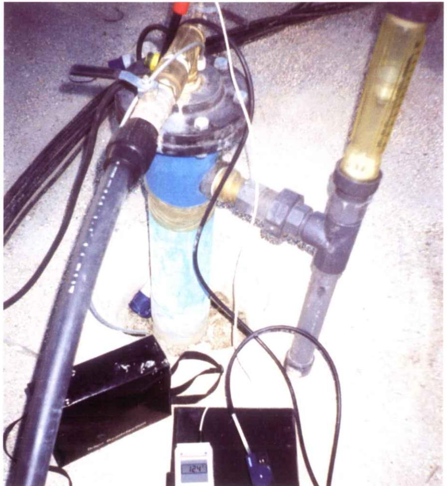
Figura 2. Medición de dióxido de carbono y caudal de aire en un pozo de extracción.
