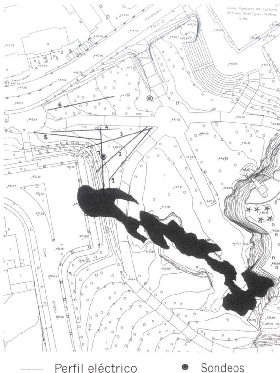
Figura 3. Disposición de los SEV's en los alrededores de la cueva. En negro, proyección en superficie de la planta de la cueva de Maltravieso.
