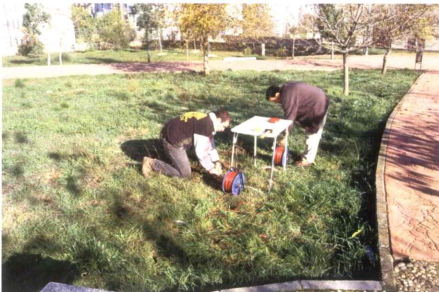
Figura 2. Toma de datos con el georresistímetro (dispositivo Schlumberger).
