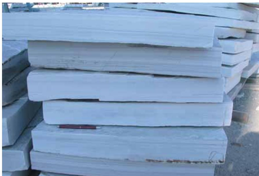
Figura 7. Losas de unos 7 cm de espesor para suelos.
