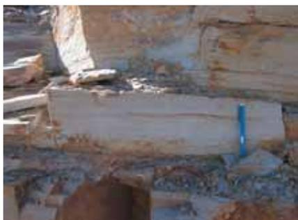
Figura 11. Detalle de las capas de cuarcita armoricana con lechos pelíticos que facilitan la obtención de placas.
