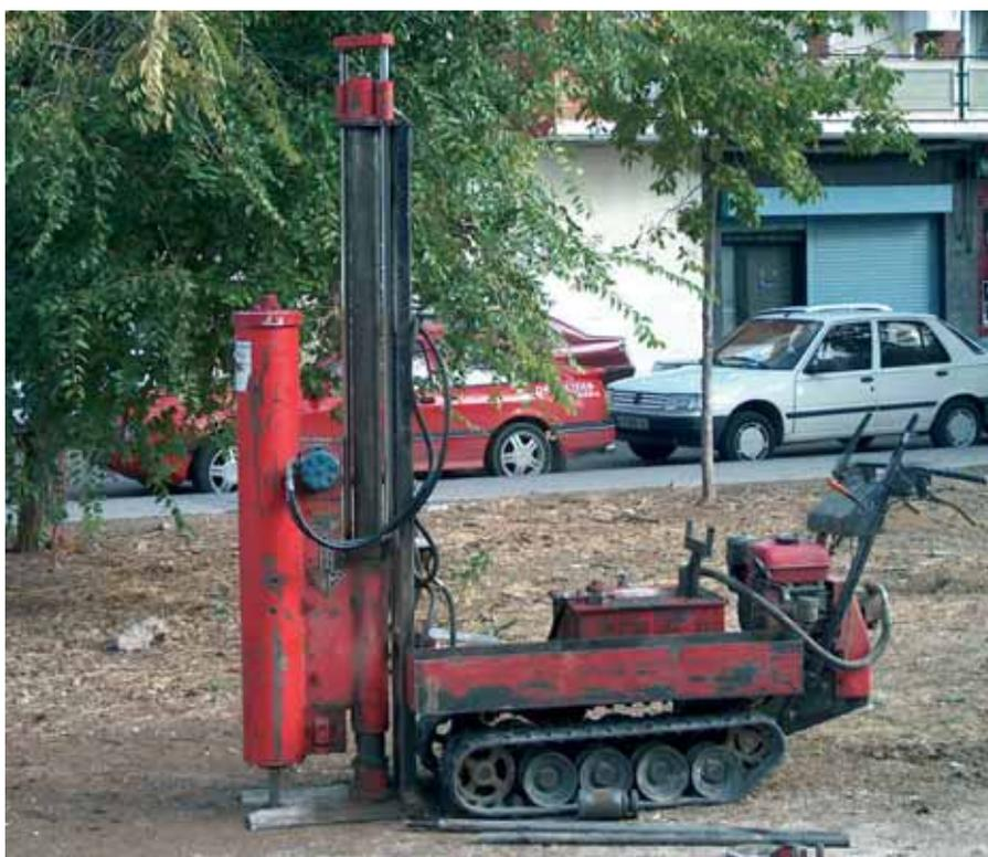
Figura 1. Ensayo de penetración dinámica.
