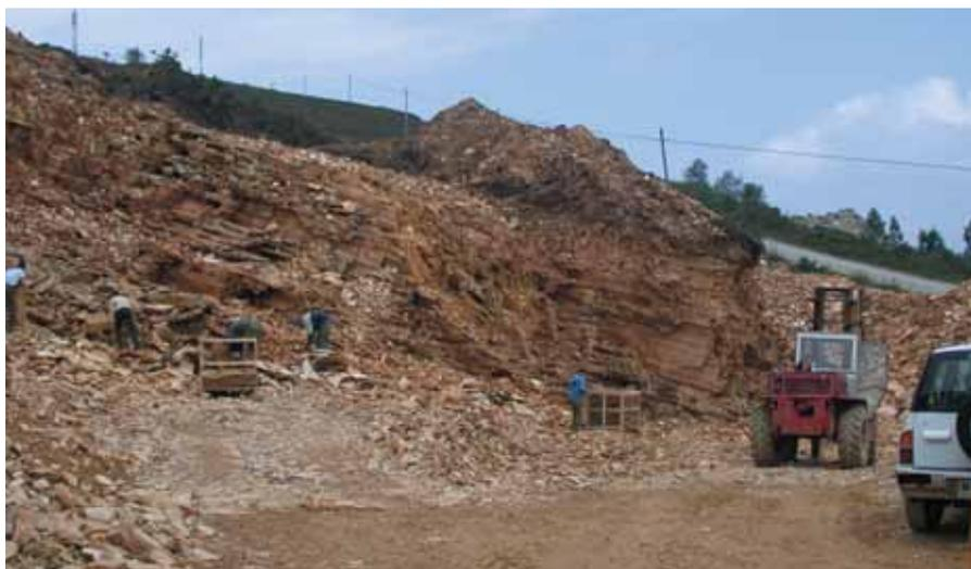
*Figura 2. Aspecto de una cantera de cuarcita en Monte Padornelo. Obsérvese el personal preparando en la cantera el producto comercial.*
