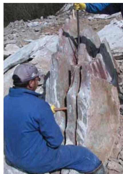
Figura 6. Operación de apertura de un bloque para obtención de placas.
