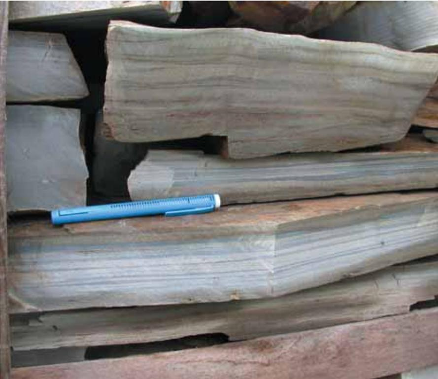
Figura 4. Detalle del material extraído con laminaciones.
