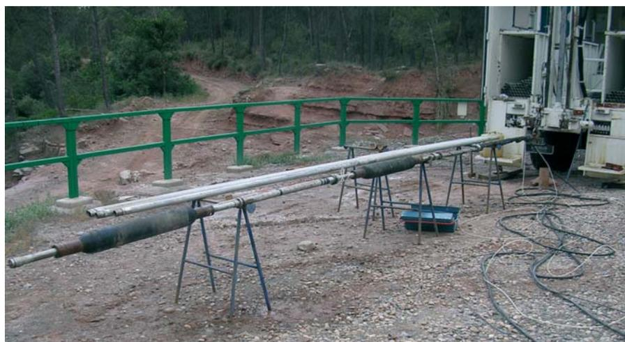
Figura 2. El equipo de profundidad con los obturadores inflados (foto M. Mejías).
