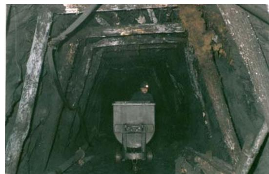
Figura 5. Galería minera con entibación de madera.
