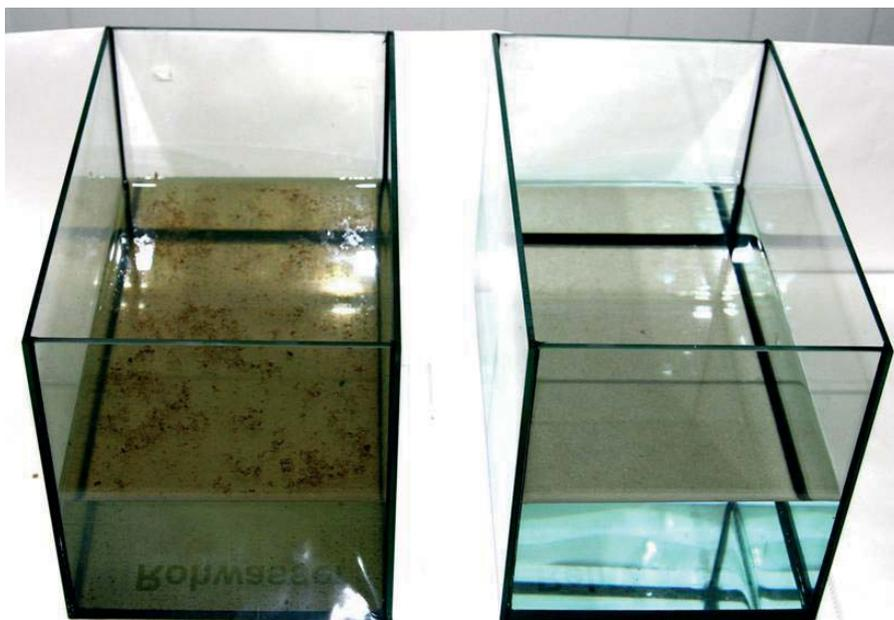
Figura 6. Agua recuperada por los pozos de extracción (*rohwasser*) y agua ya depurada (*reinwasser*).
