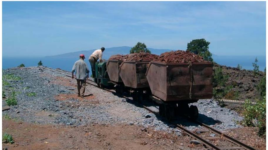
Figura 11. Carros cargados de escombros a la salida de una galería.
