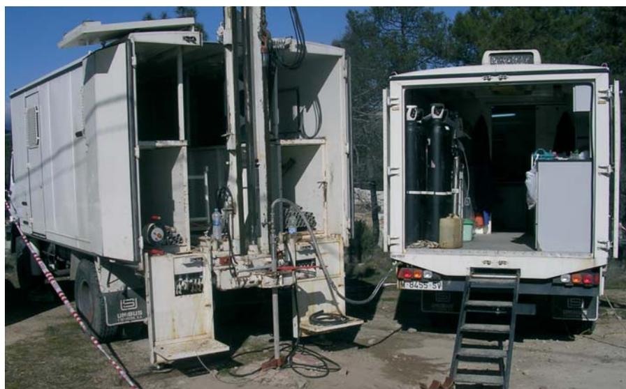
Figura 10. Unidad Móvil de Hidrogeología del IGME realizando un ensayo de inyección en régimen transitorio (foto M. Mejías).
