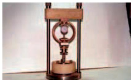
Figura 15. Ensayo Lambe para estudiar el hinchamiento de un suelo.
