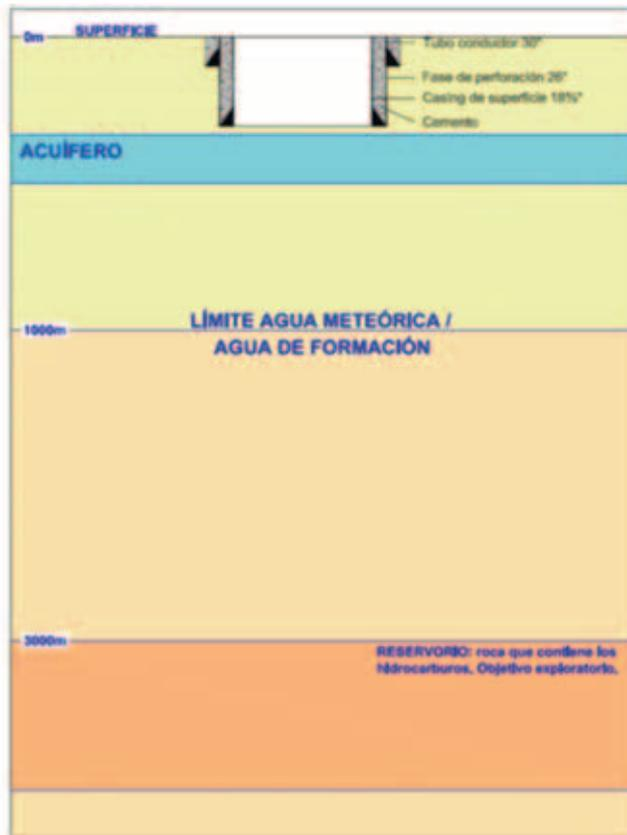
C) PERFORACIÓN, ENTUBACIÓN Y CEMENTACIÓN DEL ACUÍFERO ATRAVESADO
